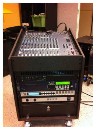
Rack på hjul som inneholder speakermikser, CD spiller, trådløs mikrofonmottager, forsterker etc
