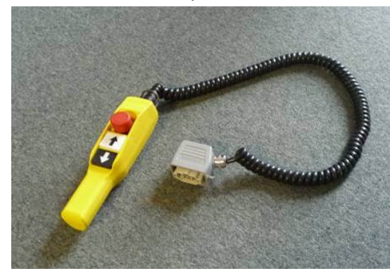
Håndkontroll med nødstop
